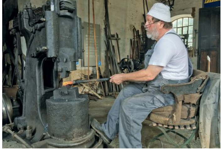
Der Schmiedemeister Kasimir Fischer bei der Arbeit mit dem Dampfhammer
